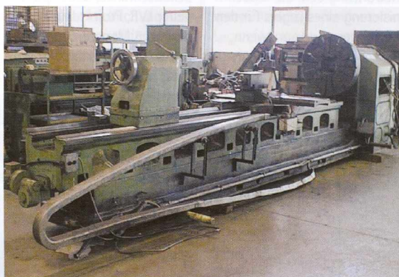
4: Maschinen lagern oft unbenutzt in Schuppen, bevor sie zu Schneider kommen. Das Maschinenbett ist oft besser als bei neuen Maschinen.
